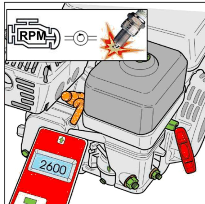
200 Инструмент тахометр цифровой
