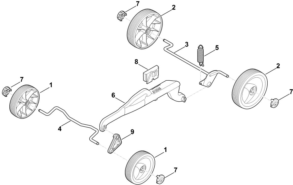
**Механизм для перемещения, регулирование по высоте**
