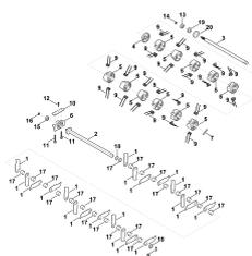
Блок аэратора, вычесыватель мха
