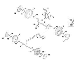
Механизм для перемещения, регулирование по высоте
