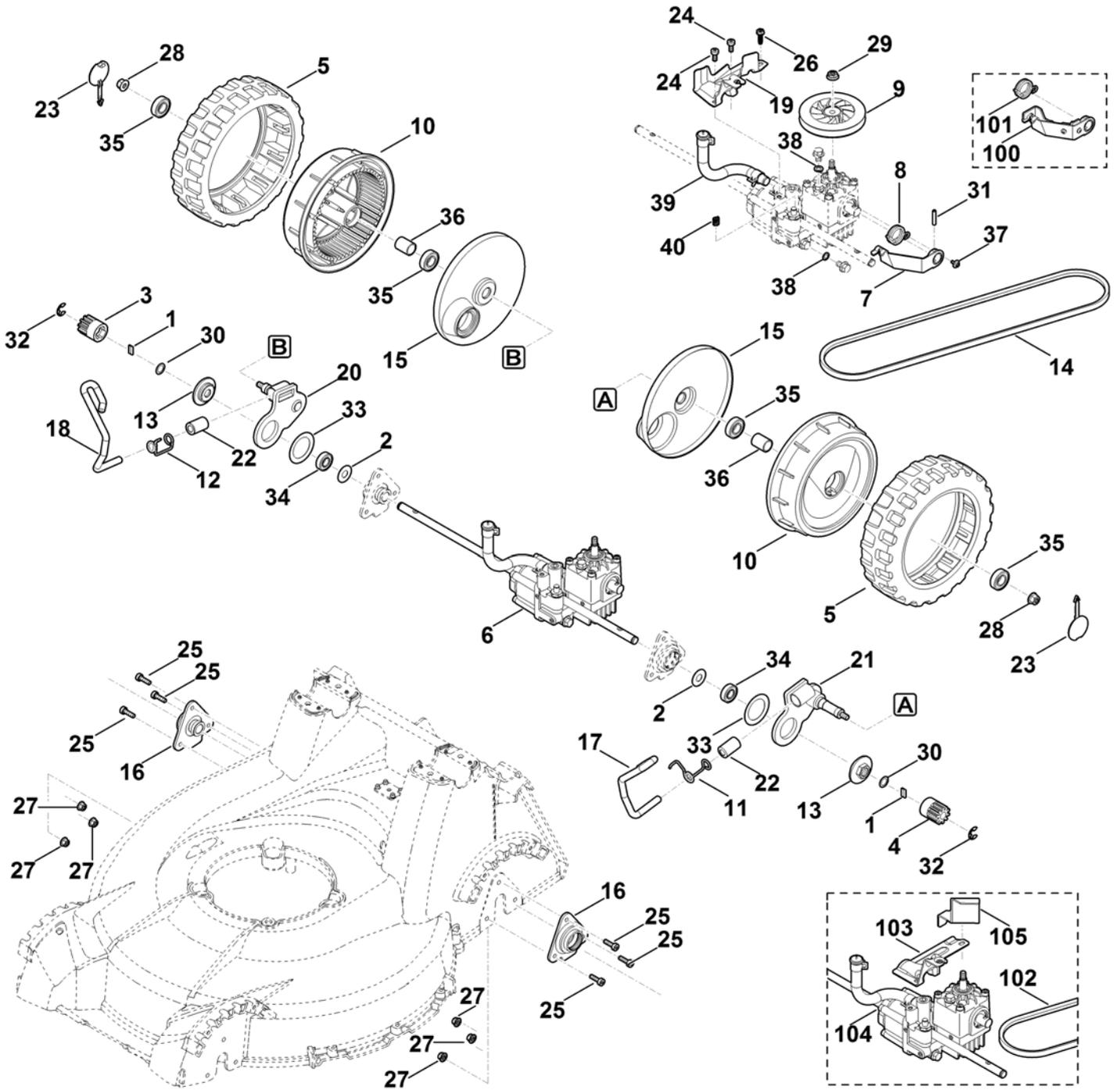
Регулировка высоты скашивания сзади, привод
