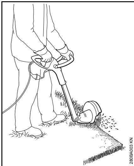
Устройство за несколько приемов может быть переоборудовано в кромкорез (см. "Переоборудование устройства в кромкорез").
