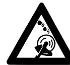
Обследовать местность: твердые предметы – камни, металлические детали и т.п. могут быть отброшены при работе – даже на расстояние 15 м – **опасность получения травмы!** – и могут повредить режущий инструмент, а также предметы (например, припаркованные автомобили, окна) – (материальный ущерб).
