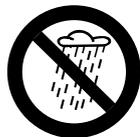
Не работать с агрегатом во время дождя, а также в мокрой или очень влажной среде – приводной двигатель не защищен от воды – **опасность вследствие удара электрическим током или короткого замыкания!**
