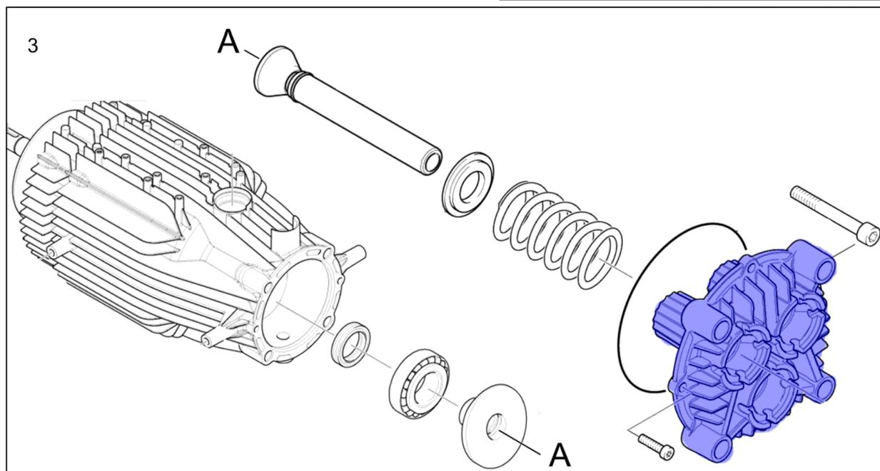
**220 Инструмент винт монтаж M6x110**
