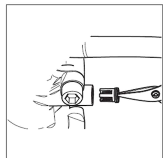
**202 Инструмент щипцы для снятия клапанов**
