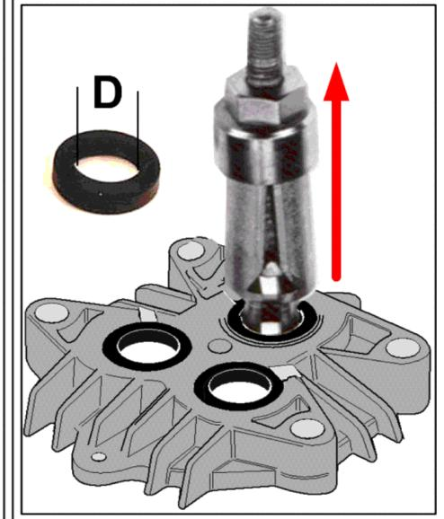
**218 Инструмент Съемник с внутренним захватом**
