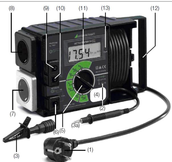
(2) Signallampe PE zur Prüfung des Netzschutzeiters
