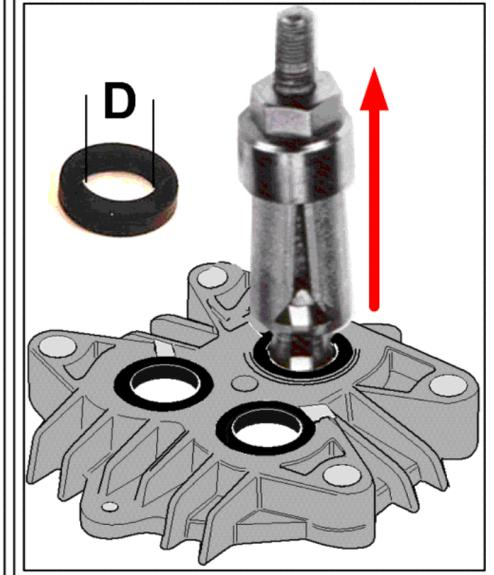
**217 Инструмент контролора Съемник с внутренн**
