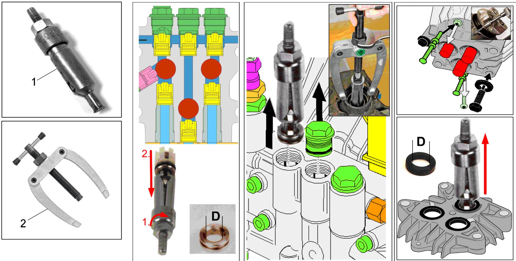
**216 Инструмент Съемник с внутренним захватом**
