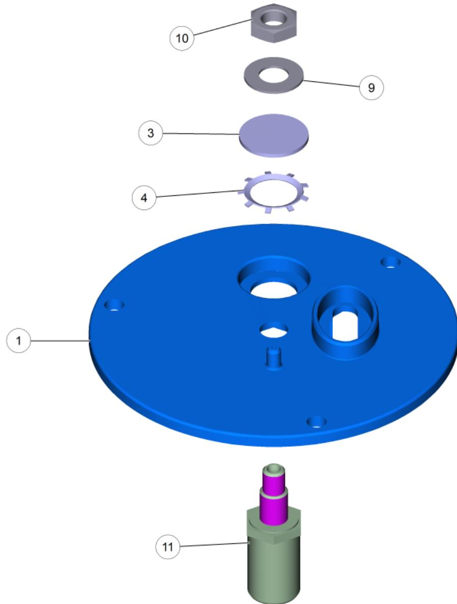
**10 Крышка напорного резервуара (4.654-218.0)**
