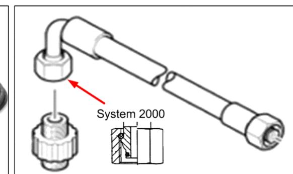
**240 Инструмент соединительная деталь -2xM22x**
