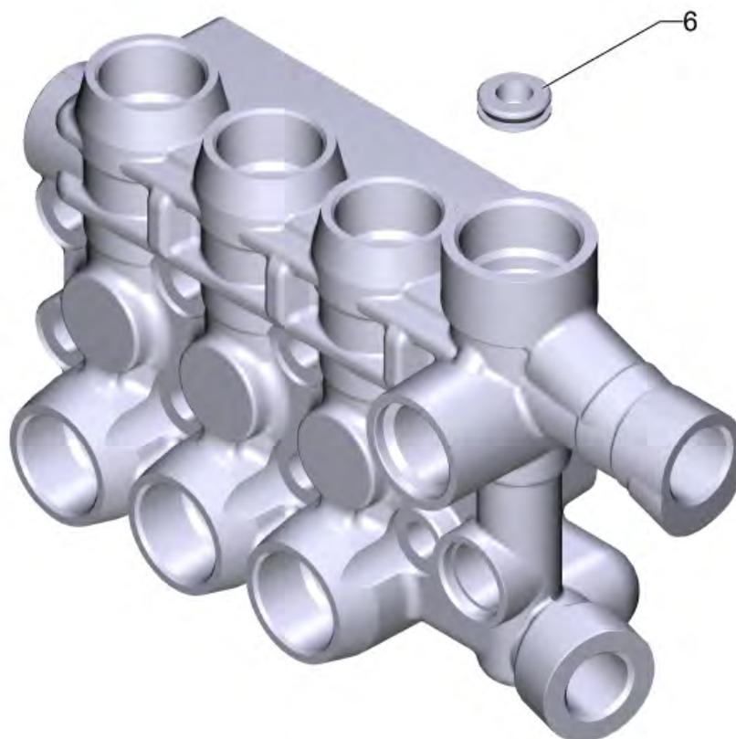
1 Головка блока цилиндра (9.751-110.0)
