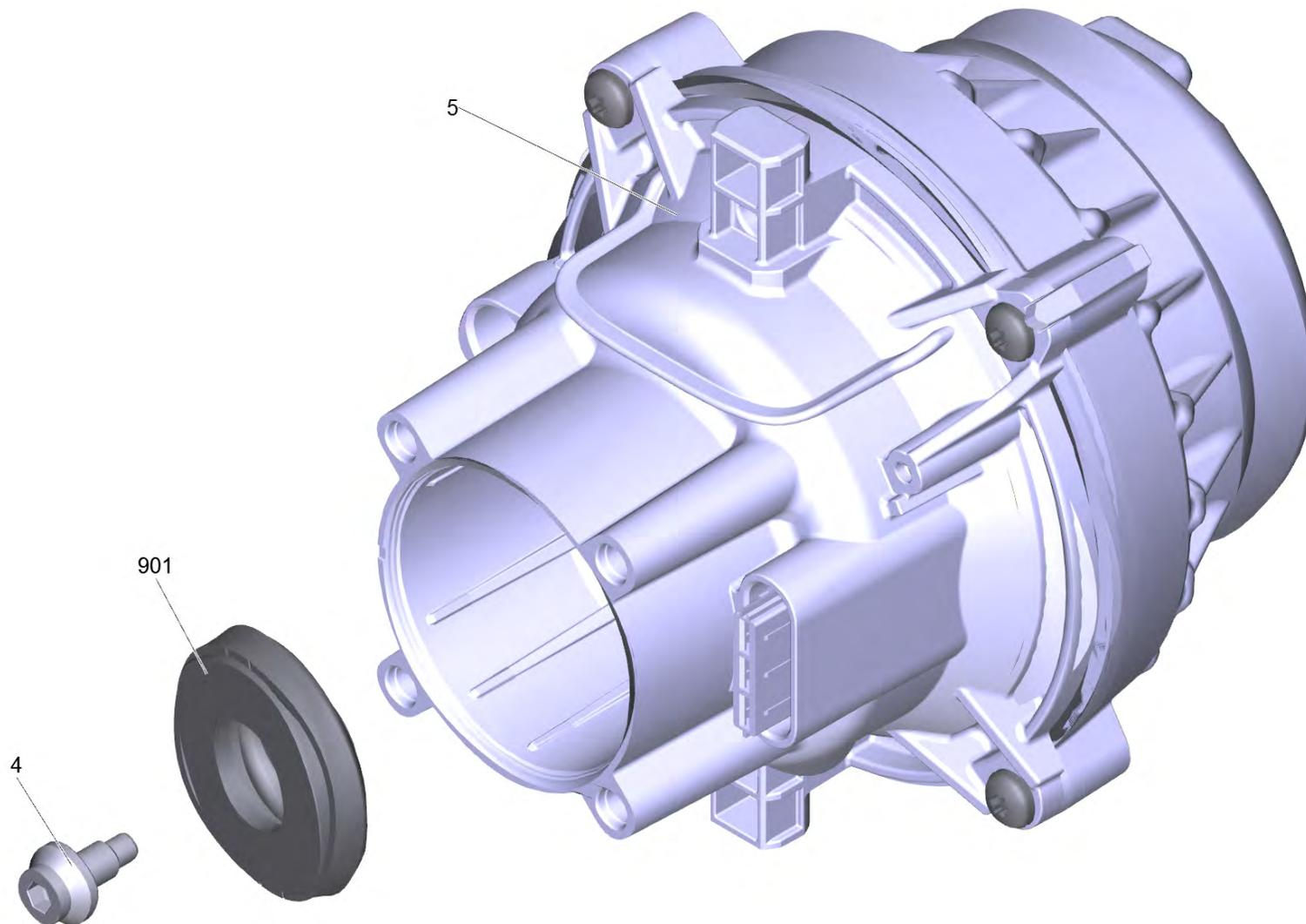
901 Мотор комплектный для замены K4 NCR (4.100-700.0)
