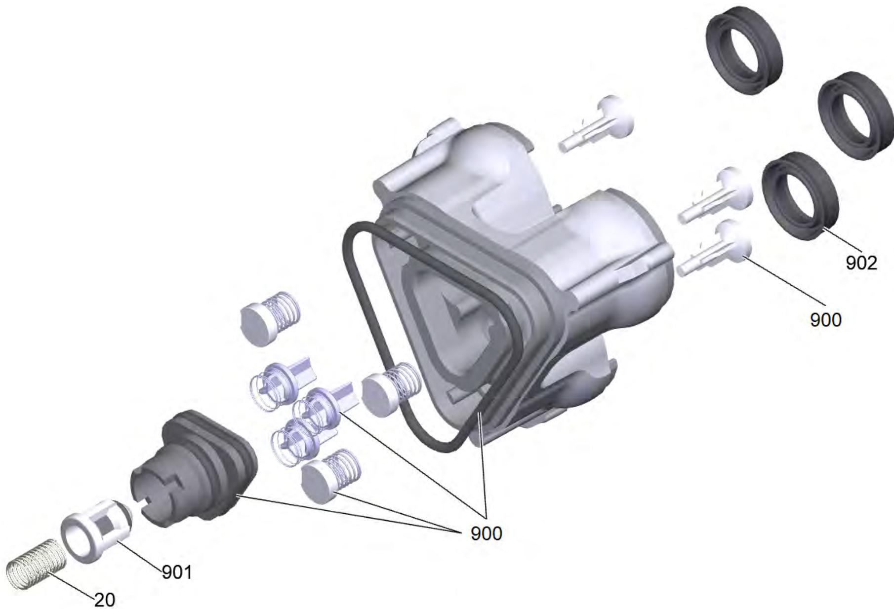
1 Головка цилиндра в сб. TRimp (9.002-619.0)
