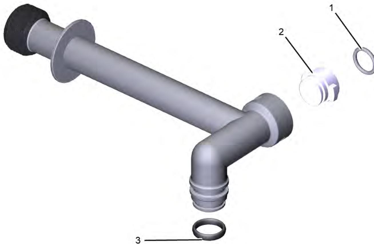
27 Труба вода подвод complete (9.751-381.0)
