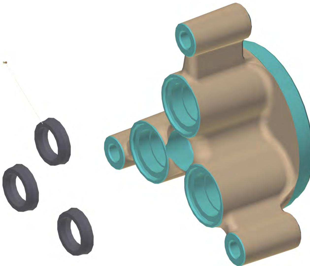
102 Цилиндрическая головка в сб. К7 (4.550-942.0)
