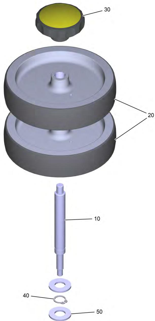
9500 Набор дефлекторный ролик стапельное сооружение SB (4.035-619.0)
