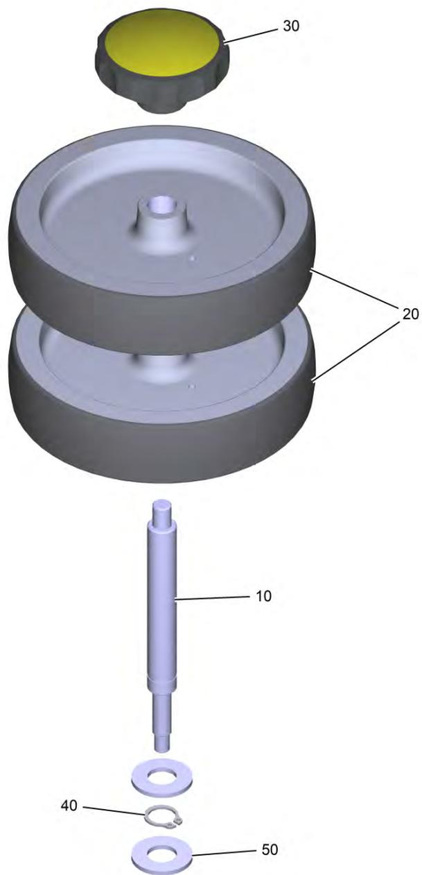
9500 Набор дефлекторный ролик стапельное сооружение SB (4.035-619.0)
