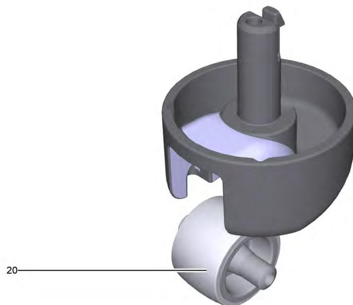
250 Рулевая стойка комплектный DD (4.512-126.0)
