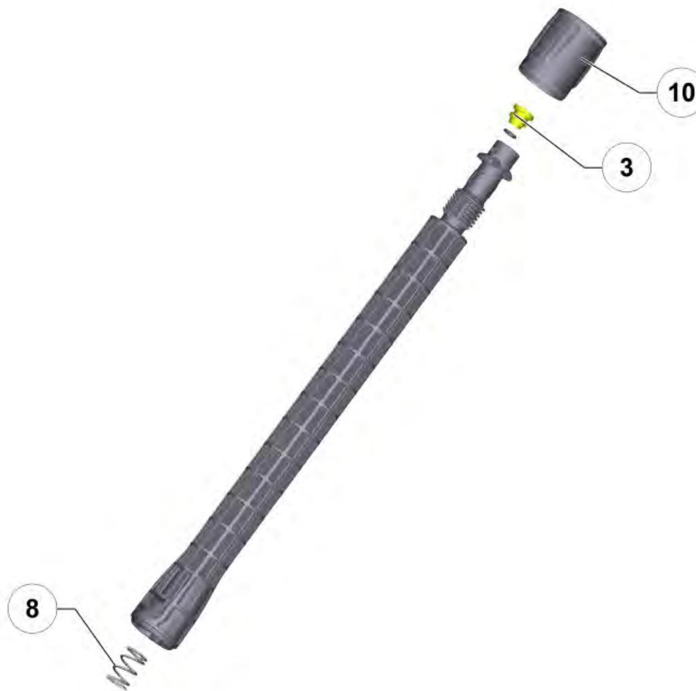
2 1-ступенчатая удлинительная трубка 0,4 м (2.643-240.0)
