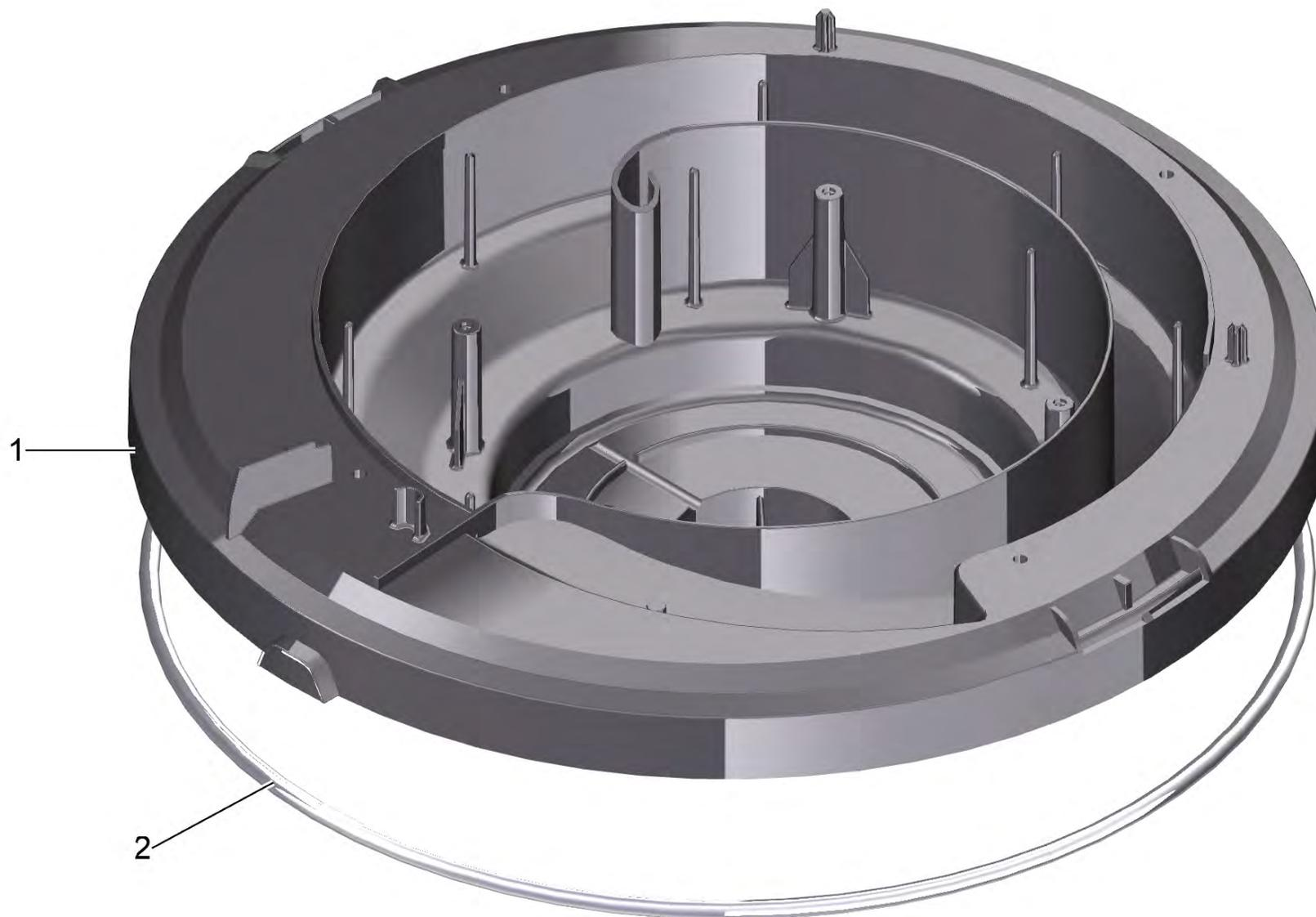
903 Фланец мотора, NT 27/1 (4.122-122.0)
