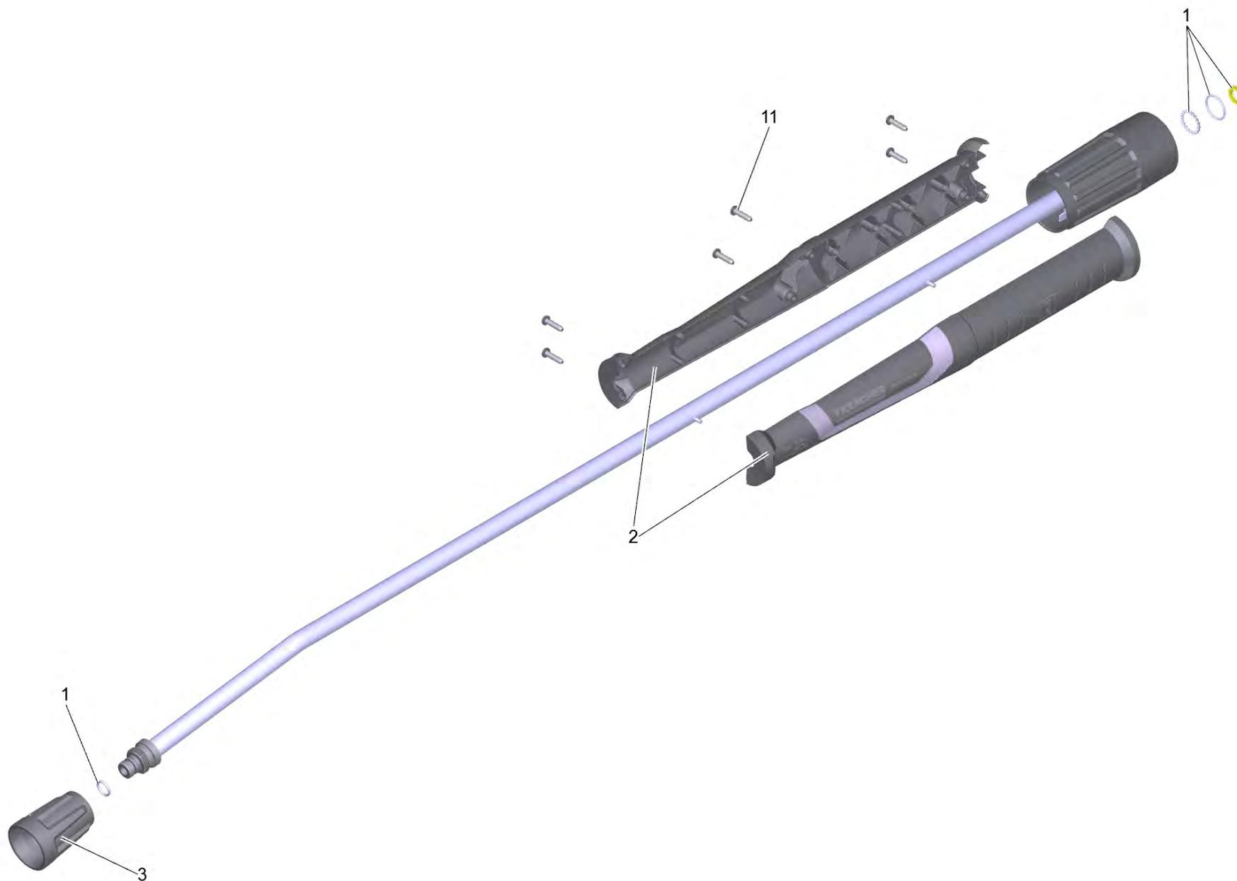
904 Струйная трубка TR 1050 mm (4.112-000.0)
