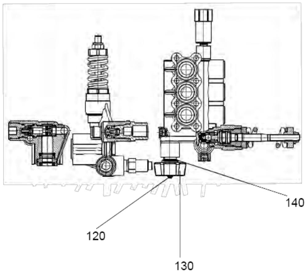
10 Головка цилиндра для замены W45-4000 (9.751-576.0)
