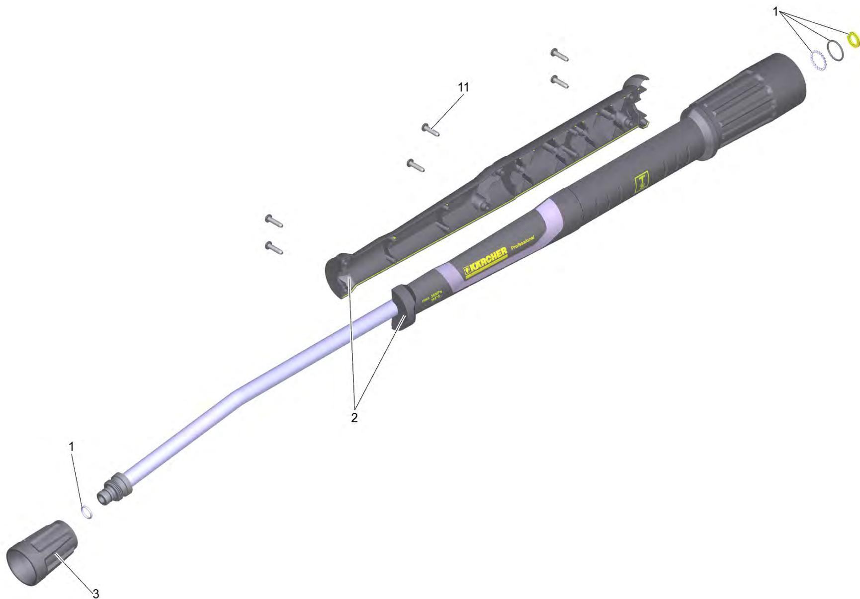
902 Струйная трубка TR 840 mm (4.112-006.0)
