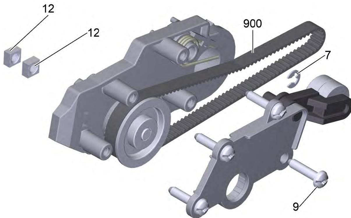
160 Привод зубчатое колесо в сб. (4.101-121.0)
