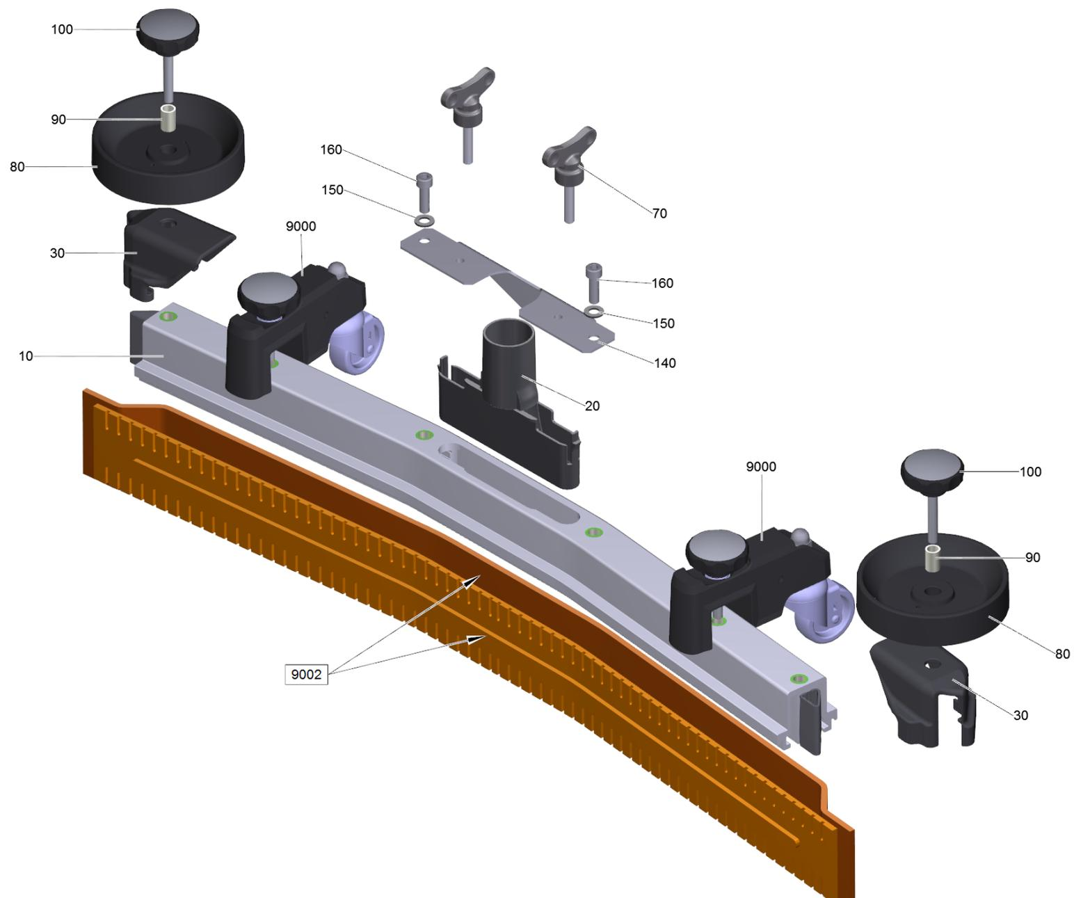
9000 Всасывающая балка изогнутая 850мм (4.777-411.0)
