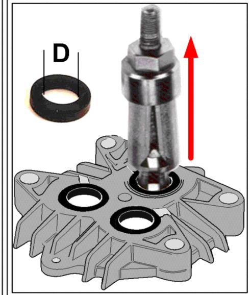
211 Инструмент Съемник с внутренним захватом (0.120-064.0)
