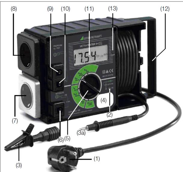
(2) Signallampe PE zur Prüfung des Netzschutzeiters
