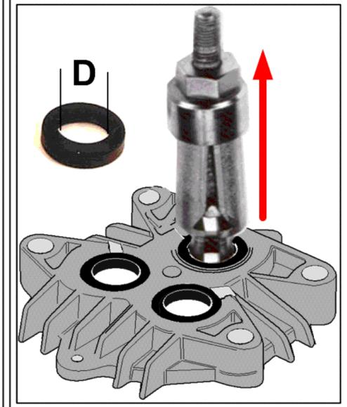
**210 Инструмент контролпора Съемник с внутренн (0.120-060.0)**
