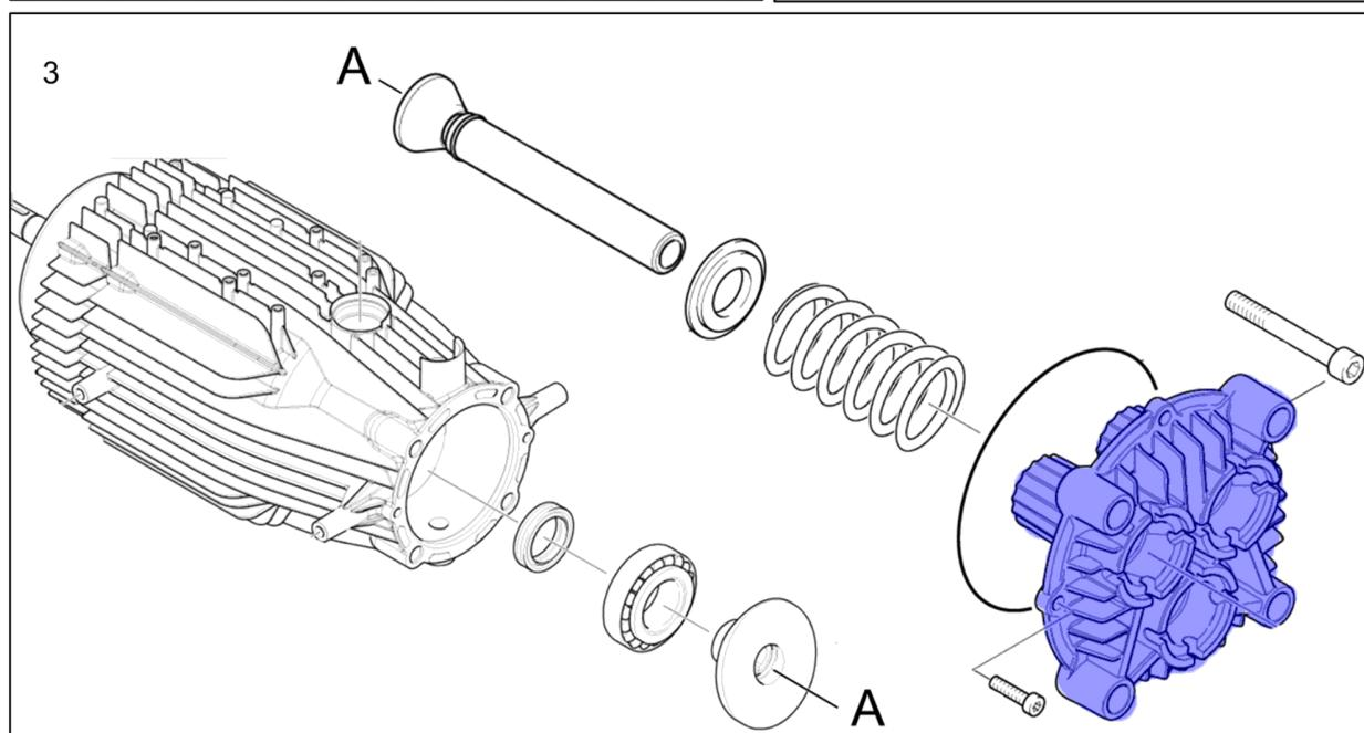
**212 Инструмент винт монтаж M6x80 (0.120-075.0)**
