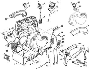
Корпус вентилятора, внутренний BG 46
