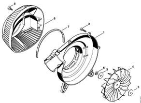
BG 45, 46: Корпус вентилятора, наружный - Крыльчатка вентилятора
