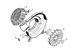
BG 55, 65, 85: Корпус вентилятора, наружный - Крыльчатка вентилятора
