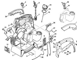
Корпус вентилятора, внутренний BG 65
