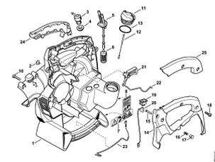
Корпус вентилятора, внутренний BG 65 (45.2001)
