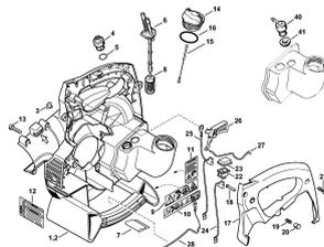
Корпус вентилятора, внутренний BG 45, 55
