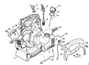
Корпус вентилятора, внутренний BG 45, 55 (45.2001)
