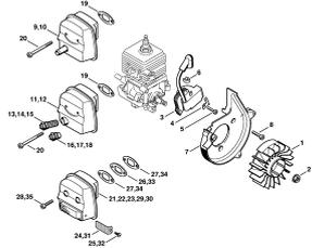
Система зажигания - Шумоглушитель
