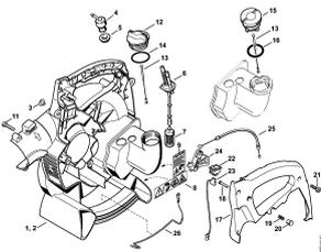
Корпус вентилятора, внутренний BG 45, 55 (04.2001), (45.2001), (18.2002)
